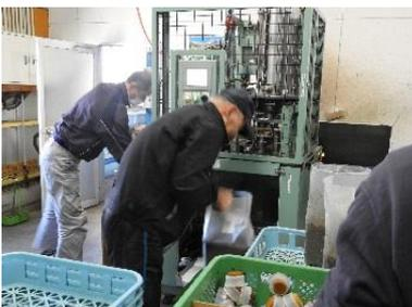
⑤攪拌された、培地が、菌床パックに詰められて攪拌機から出てくるので、専用のトレーに4個ずつ置いていく
